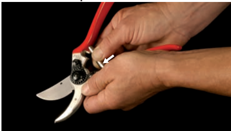
14. Mettre en place le ressort
