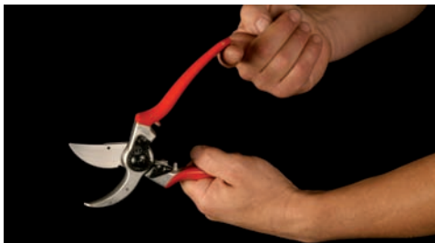
12. Positionner et serrer le secteur denté
