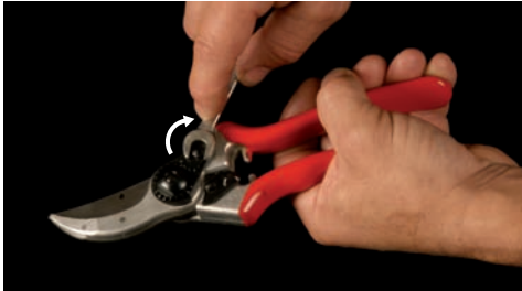
14. Mettre en place le ressort
